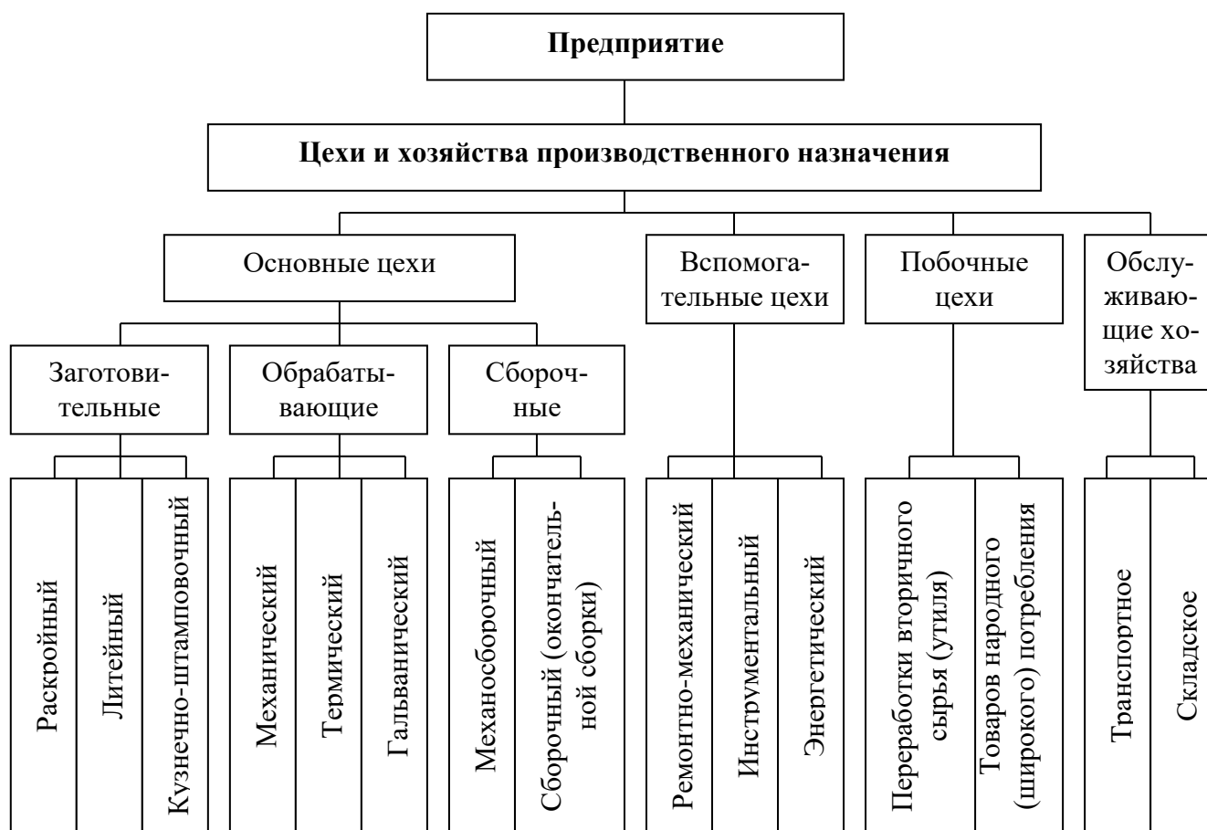
Рисунок 3.3 – Схема цеховой производственной структуры машиностроительного предприятия
